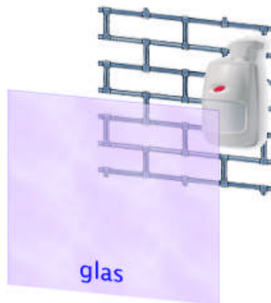
Detector tussen rolluik en glas
